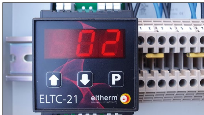
Am ELTC-21 kann der Installateur die Zieltemperatur einstellen. Wird diese unterschritten, schaltet die Antennenheizung selbstständig ein
